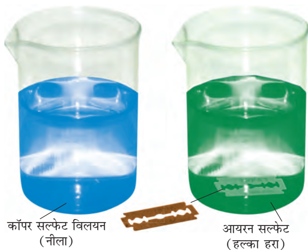
चित्र 6.4 लोहे के साथ अभिक्रिया के कारण कॉपर सल्फेट विलयन के रंग में परिवर्तन
