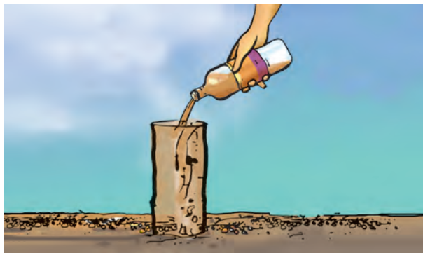
चित्र 9.5 अंतःस्त्रवण दर को मापना
