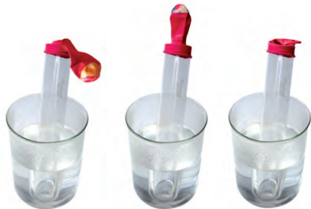
क्वथन नली के मुख पर बँधा गुब्बारा गर्म जल में डूबी हुई क्वथन नली बर्फ के ठंडे जल में डूबी हुई क्वथन नली
